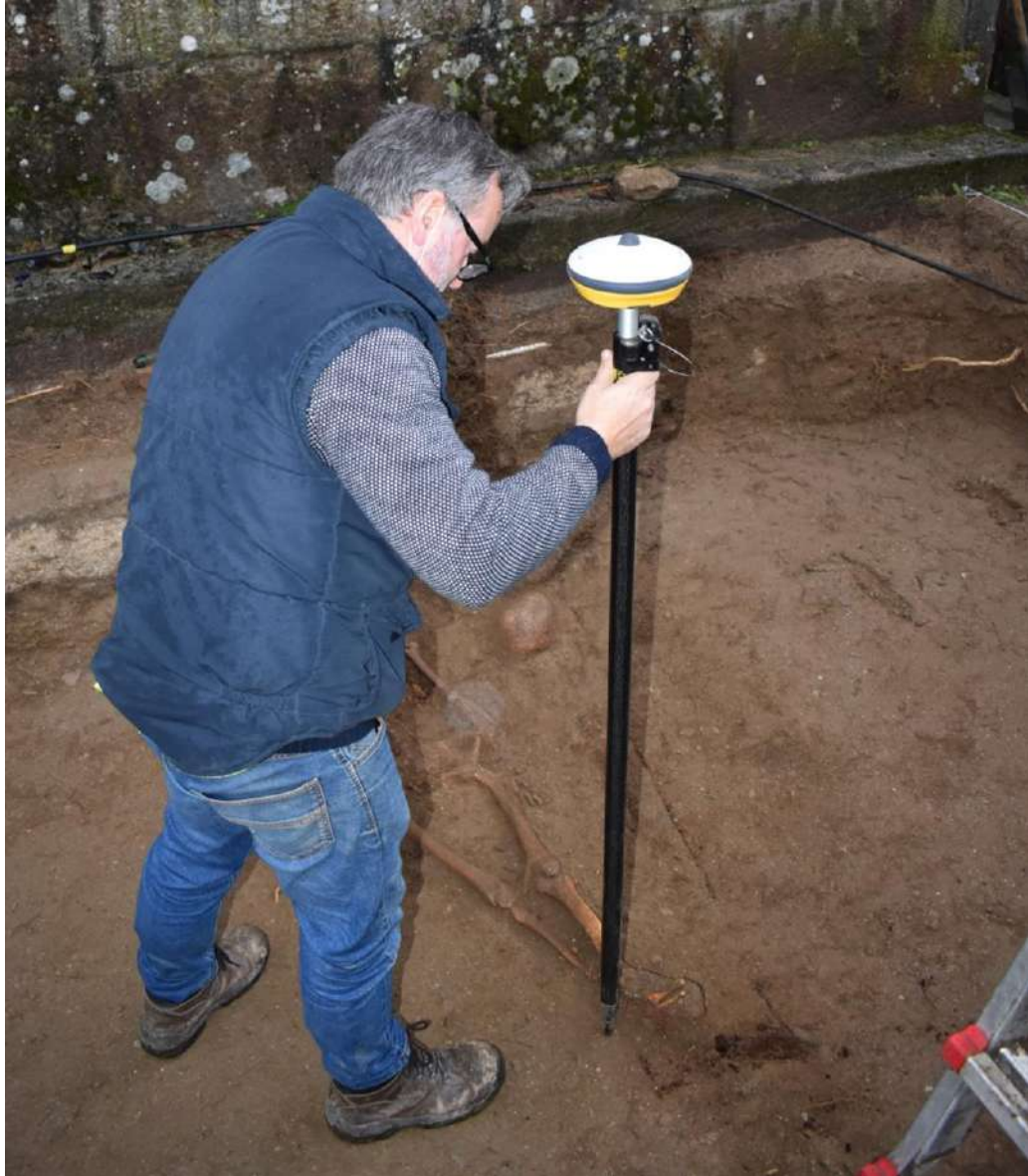
Imaxe 14: Proceso de toma de cotas da UE17 con GPS subcentimétrico
