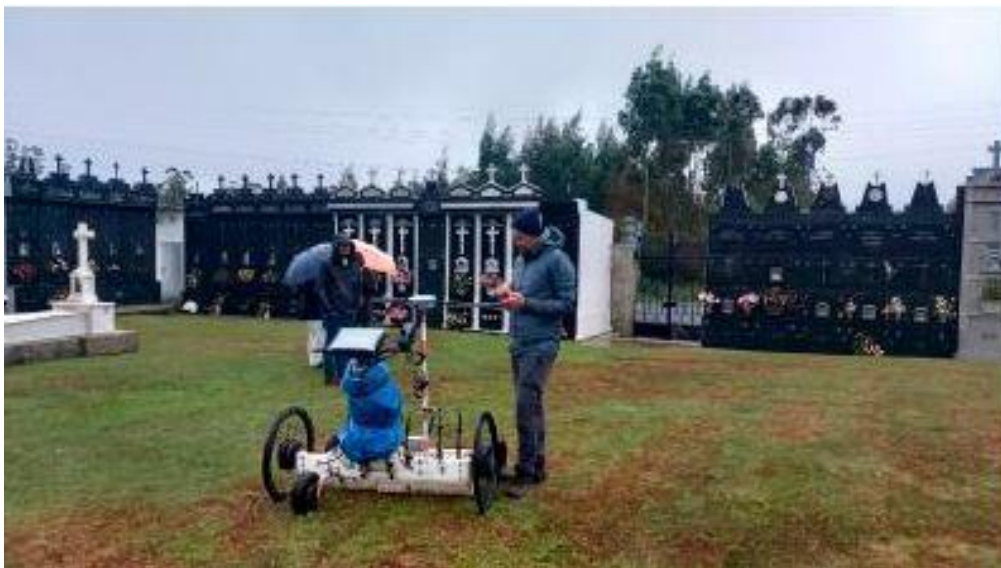
Prospección con xeorradar IDS RIS FASWave SOT no cemiterio de Santiago de A Capela
